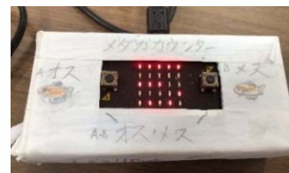
【図5】自作micro:bitカウンター
